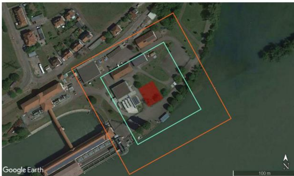
Abbildung 12: Notwendige Abstände zum Hochdruckbereich der Neuanlage
